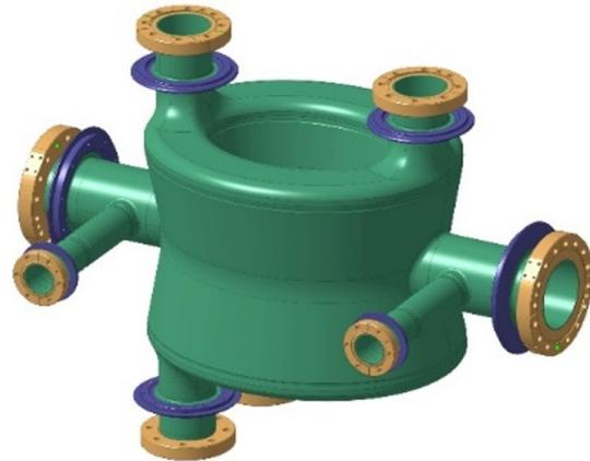
Figure 1: The DQW cavity geometry.
