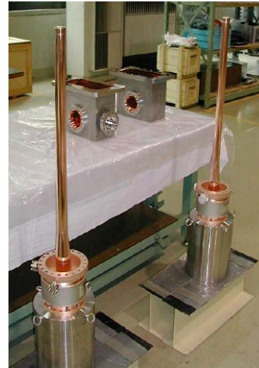
972 MHz J-ADS Input Coupler (KEK)
