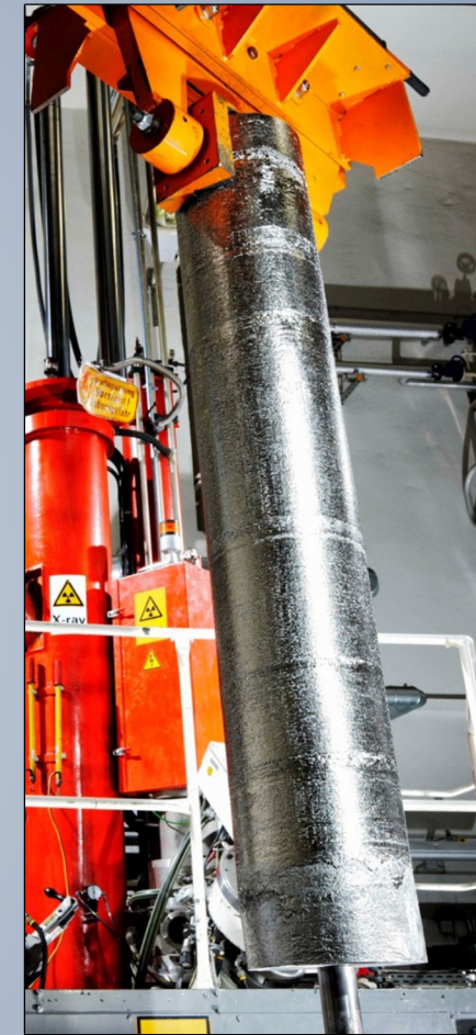
Nb ingot after EBM at Heraeus (D)
