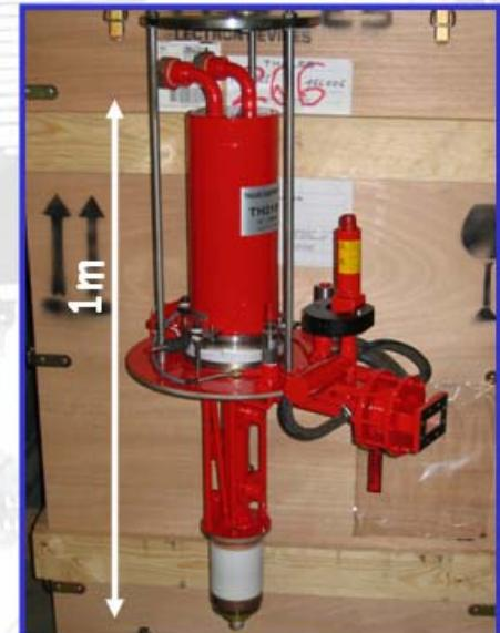
4.90GHz/50kW cw klystron TH2166:
