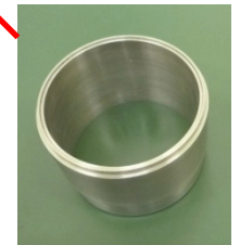
Input-port pipe (Nb)
